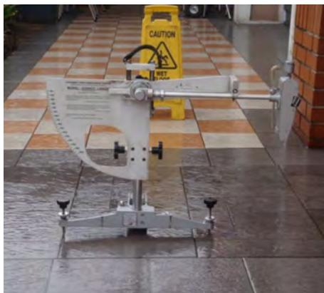
FIGURA 110. Ensayo péndulo en pavimento exterior. FIGURA 111: Ensayo péndulo en pavimento exterior. Fuente: [www.floorsliptest.com.au](http://www.floorsliptest.com.au).
