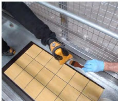
FIGURA 119: Ensayo rampa pies calzados. Fuente: [www.laboratorioresbaladicidad.com](http://www.laboratorioresbaladicidad.com) con FIGURA 120: aplicación contaminante aceite en calzado. Fuente: [www.floorsliptest.com.au](http://www.floorsliptest.com.au).
