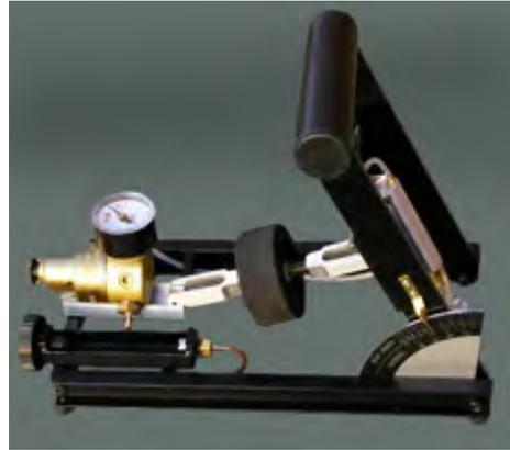
FIGURA 126: Aparato Brungraber Mark II. Fuente: [www.systemanet.it](http://www.systemanet.it). FIGURA 127: Aparato English XL. Fuente: [www.americanbioengineers.com](http://www.americanbioengineers.com).
