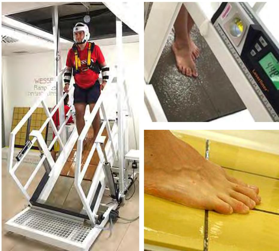
FIGURA 18, 19 y 20: Ensayo de rampa pies mojados. Fuente: [www.laboratoriodesesbaladicidad.com](http://www.laboratoriodesesbaladicidad.com).
