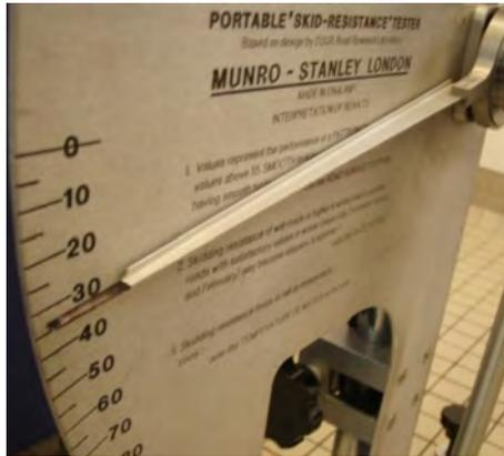
FIGURA 112: Método del péndulo. Obtención valores. Fuente: [www.floorsliptest.com.au](http://www.floorsliptest.com.au).
