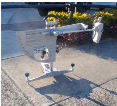
FIGURA 13. Ensayo péndulo en pavimento exterior. Fuente: [www.floorsliptest.com.au](http://www.floorsliptest.com.au).
