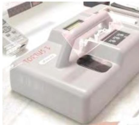
FIGURAS 23 y 24: Método de ensayo TORTUS. Fuente: [www.laboratorioderesbaladicidad.com](http://www.laboratorioderesbaladicidad.com).
