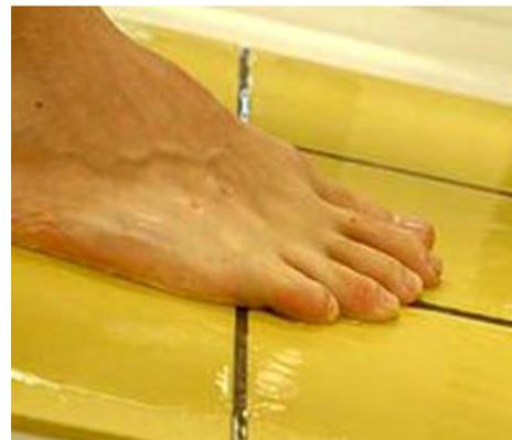
FIGURAS 114, 115 y 116. Ensayo de rampa pies mojados. Fuente: [www.laboratorioderesbaladidad.com](http://www.laboratorioderesbaladidad.com)
