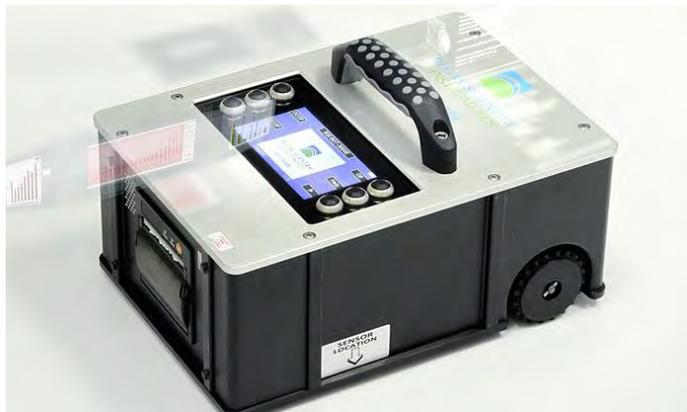
FIGURA 123: Aparato ensayo ASTM-C 1028. Fuente: [www.systemanet.it](http://www.systemanet.it). FIGURA 124: Aparato ensayo BOT-3000e. Fuente: [www.laboratorioderesbaladicidad.com](http://www.laboratorioderesbaladicidad.com).
