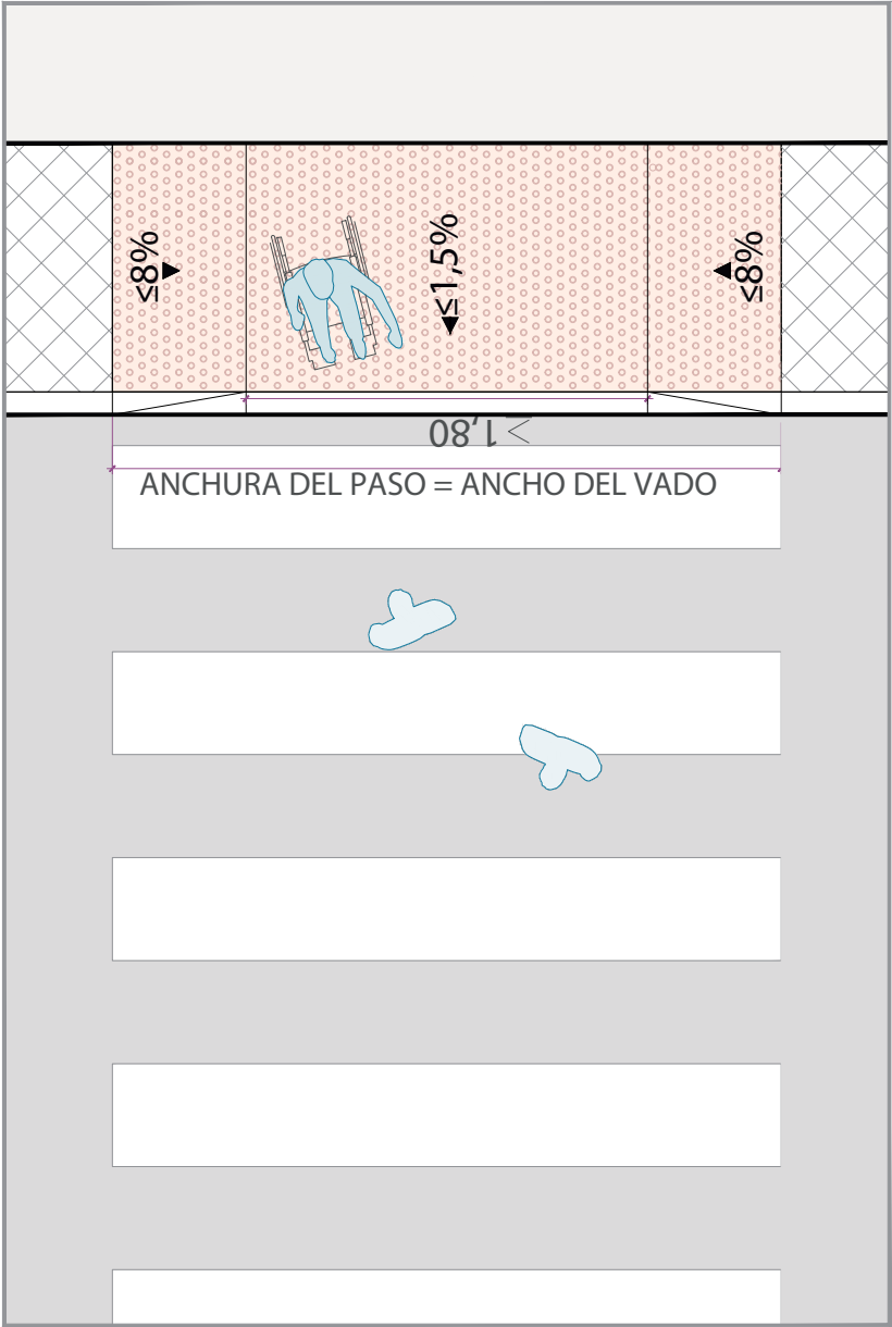
Gráfico U.4.5. Vado de peatones con dos pendientes. Configuración en Planta. Cotas en cm.
