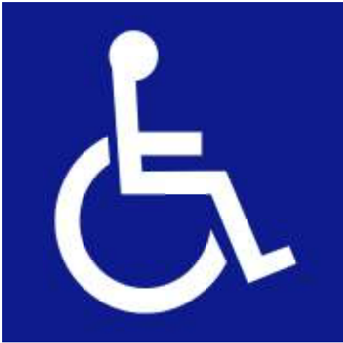
Gráfico C.1.2. Acabados del SIA: fondo en color azul (Pantone 294) con la imagen en color blanco con la cara hacia la derecha
