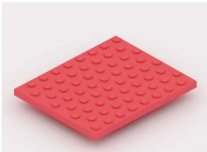
Gráfico U.9.4. Pavimento táctil de botones, vista tridimensional.
