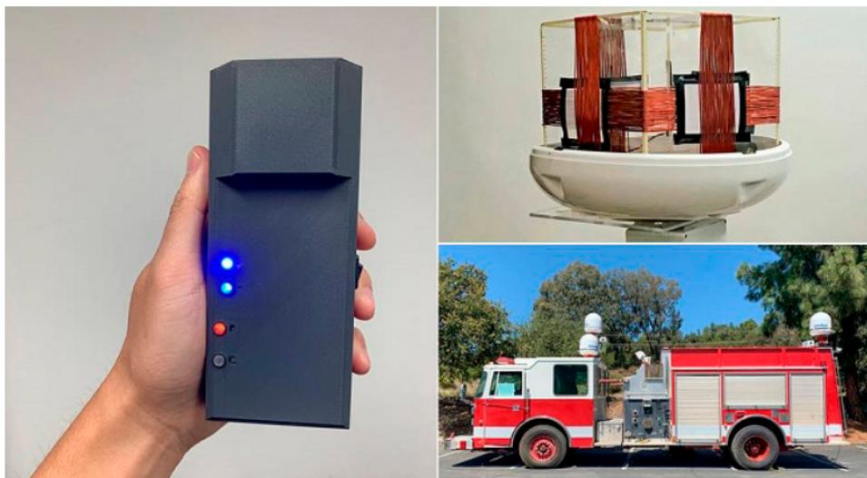
**Imagen 29:** Emisor y receptor POINTER, detalle de la antena y montaje en camión de bomberos (fuente: NASA/JPL-Caltech/DHS S&T)
