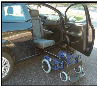
Ilustración 10.- Asiento de vehículo convertible en silla de ruedas
