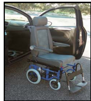
Ilustración 10.- Asiento de vehículo convertible en silla de ruedas
