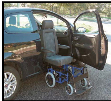
Ilustración 10.- Asiento de vehículo convertible en silla de ruedas
