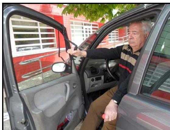
Ilustración 1.- Agarrador colocado en la parte superior del marco de la ventana del vehículo.
