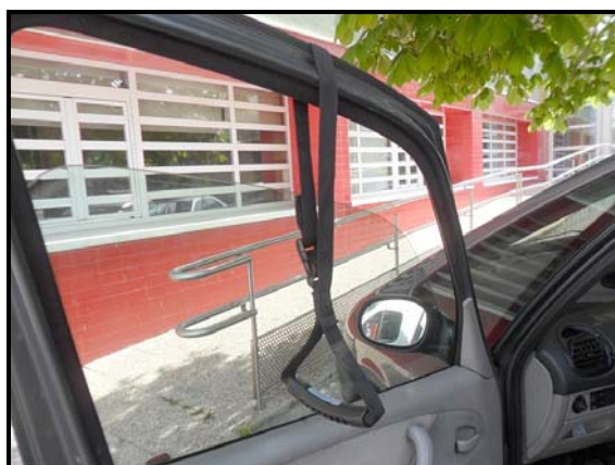
Ilustración 1.- Agarrador colocado en la parte superior del marco de la ventana del vehículo.
