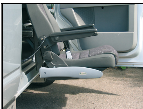
Ilustración 8.- Dispositivo que permite girar, subir y bajar el asiento
