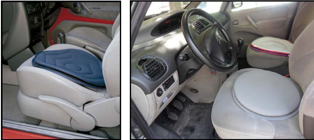
Ilustración 4.- Cojín giratorio sobre asiento de vehículo
