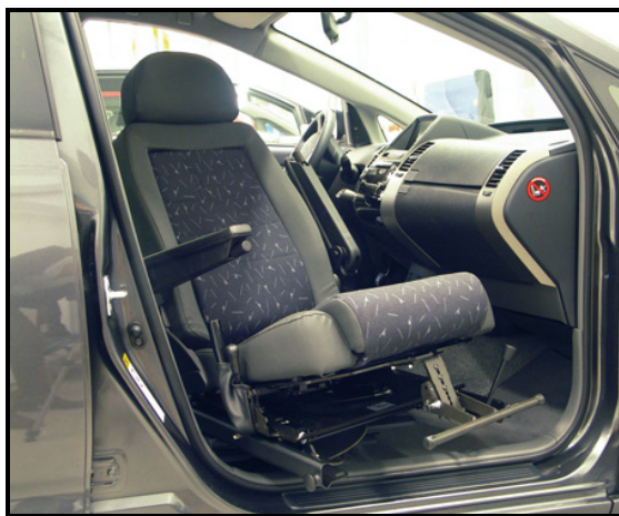
Ilustración 7.- Dispositivo que permite bascular el asiento
