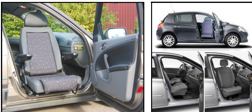
Ilustración 6.- Base giratoria en asiento de vehículo
