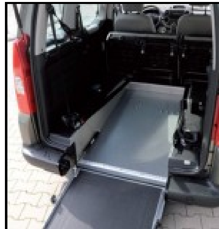
Ilustración 13.- Rebaje de suelo
