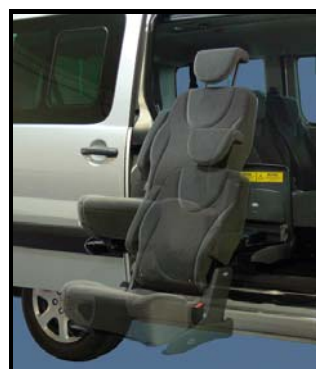
Ilustración 8.- Dispositivo que permite girar, subir y bajar el asiento
