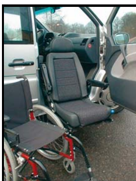
Ilustración 8.- Dispositivo que permite girar, subir y bajar el asiento
