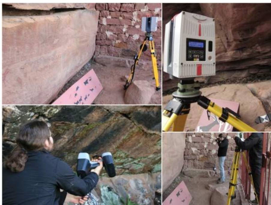
Aplicación de diferentes metodologías para la documentación geométrica de conjuntos rupestres: escáner láser, escáner de luz blanca estructurada y estación total.
