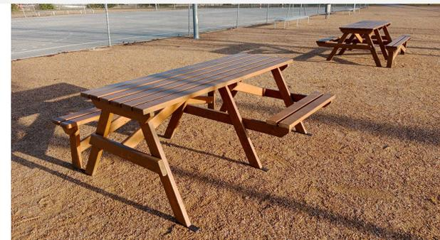
Ejemplo de mesa que permite la aproximación de una persona usuaria de silla de ruedas, con bancos de diseño inadecuado para el resto de usuarios
