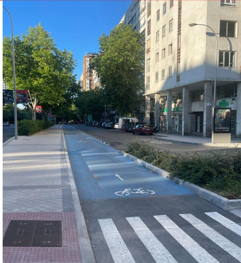
Carril bici integrado en calzada. Nótese el pavimento táctil direccional en la mediana, hasta el vado peatonal (inferior derecha). Paseo de la Castellana, Madrid
