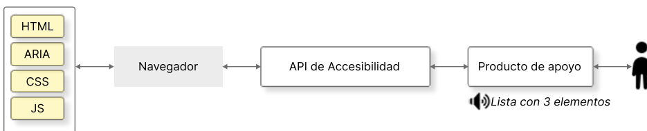
Ilustración 30. Esquema de comunicación entre el navegador y el producto de apoyo a través de la API de accesibilidad. Ejemplo de lista de elementos.
