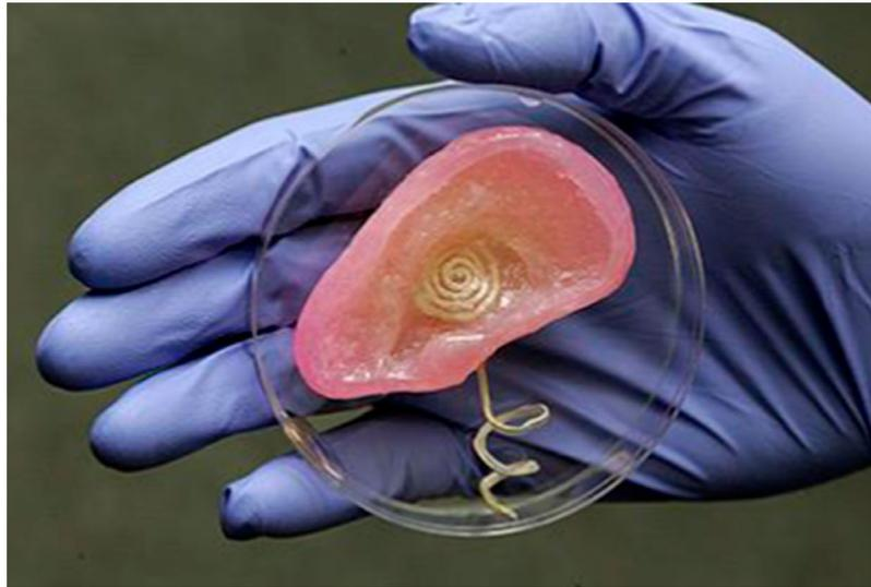
Prototipo de oído biónico fabricado en impresora 3D con material orgánico. *Princeton University*
